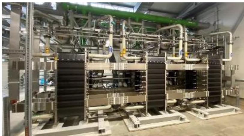
Électrolyseur PEM de Siemens Energy
