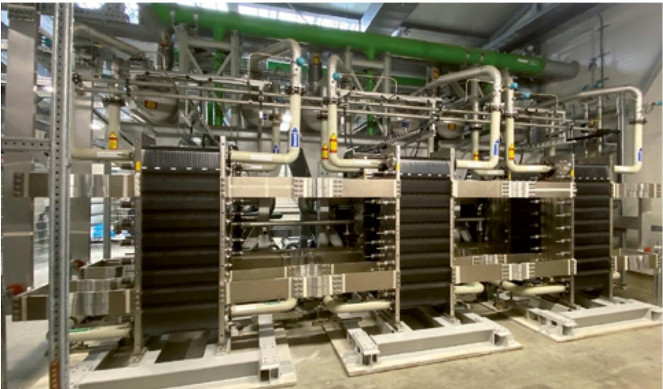
Figure 21 - Électrolyseur PEM de Siemens Energy
