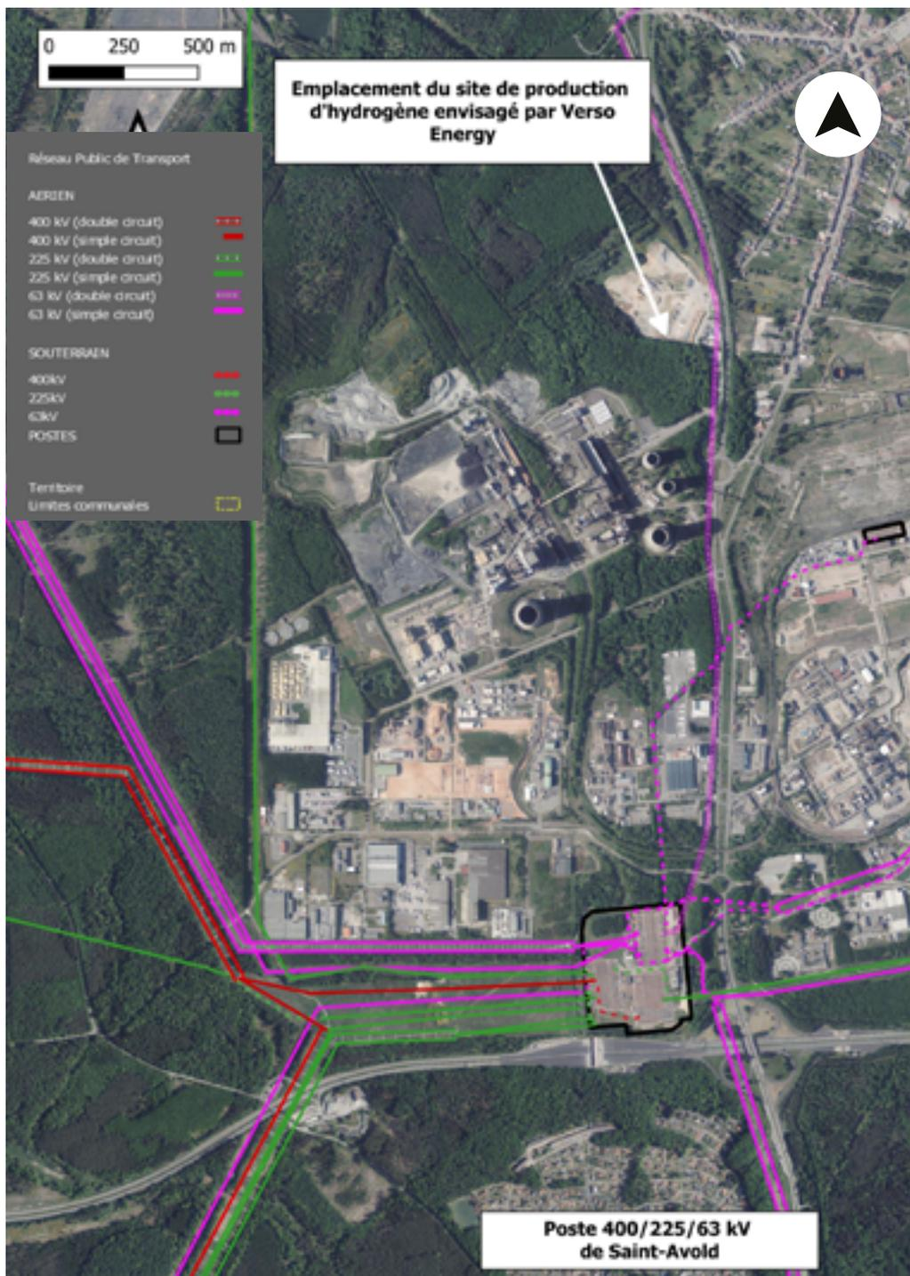
Figure 27 - Emplacement du poste RTE à Saint-Avold et liaisons électriques existantes
