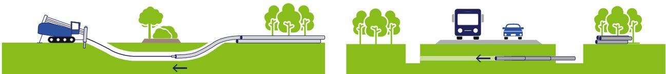
Figure 32 - Schéma de pose sans tranchée en sous-œuvre
