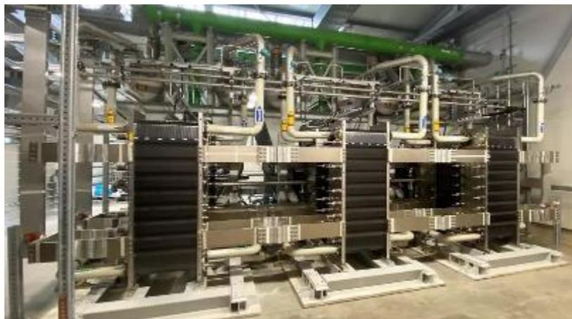
Électrolyseur PEM de Siemens Energy
